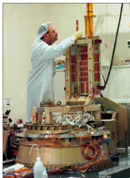
Figuur 7. Integratie van thermische stralers op het kwalificatiemodel van de SPI-spectrometer.
